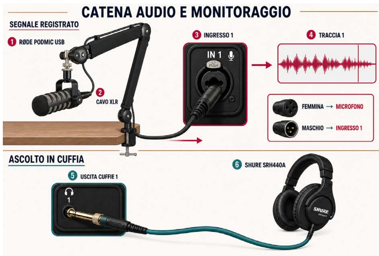
Figura 11 - Catena audio e monitoraggio: il microfono entra via XLR nel RØDEcaster Pro II e la cuffia consente di controllare la voce prima e durante la registrazione.
